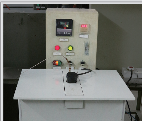
Baño de prueba con hipoclorito de sodio
