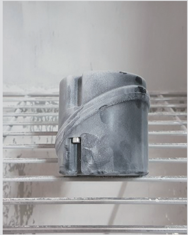
Carcasa durante la prueba IP6x
